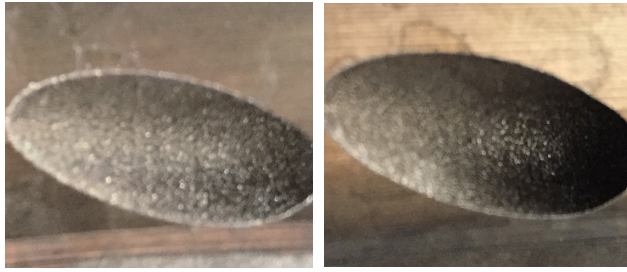
图10 正式件的钎焊缝状态示意图
