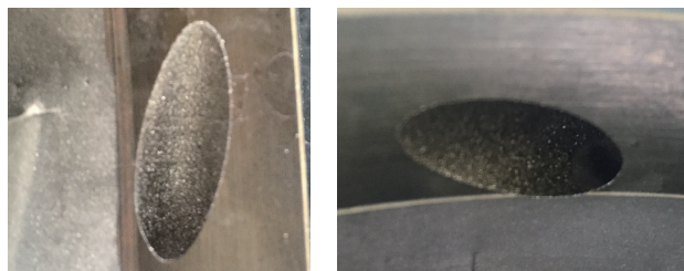
图9 工艺试验的钎焊缝状态示意图
